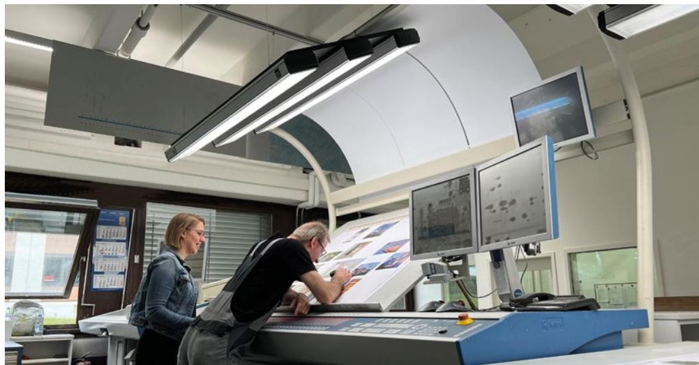
**Abmusterung an einer Offsetdruckmaschine mit der JUST DLS-Retrofit-Lösung. Farbprüfstationen von Drittanbietern lassen sich mit diesem System umrüsten.**
